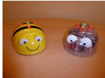
Enthalten sind darin Bee- und Bluebots; das sind kleine Bodenroboter, die durch Richtungstasten auf der Roboterrückseite von Kindern programmiert werden können. Durch ihre kindgerechte Gestaltung und einfache Bedienung regen Bee- und Bluebots zum Ausprobieren an. Dabei können verschiedene Befehle eingegeben werden: vorwärts, rückwärts, Drehung nach rechts/links um 90°, Pause und Löschen.
